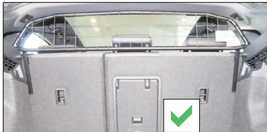
2 Insert Guard - Badge to the back of car Teil einfügen - Plakette zum Fahrzeugheck hin
