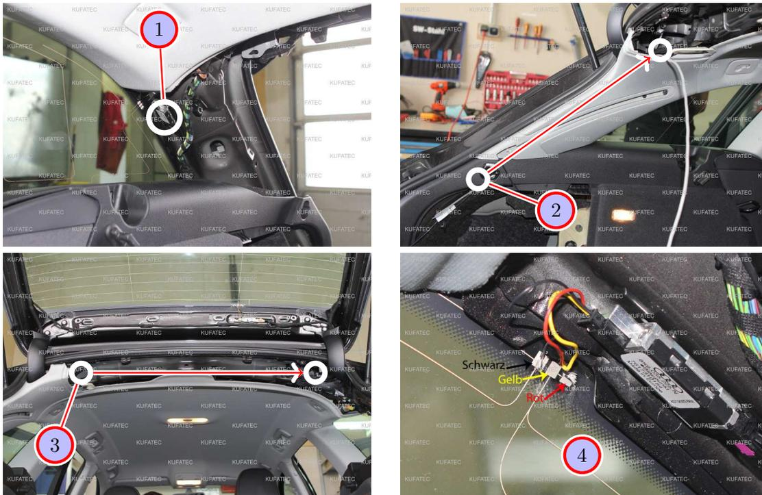
Abbildung 3: Verlegen der Antennenleitung und Lötunkte setzen
