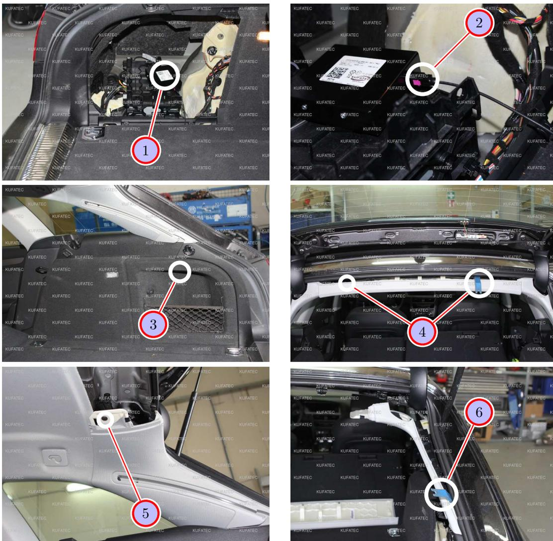
Abbildung 2: Anschluss Fistune und Verkleidungen im Kofferraum ausbauen
